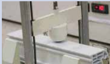
Soğukta Darbe Dayanımı Testi
